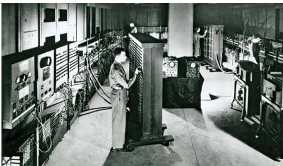
Fig. 2. ENIAC ( Electronic Numerical Integrator and Computer ) fu il primo computer elettronico digitale programmabile. Completato nel 1946, occupava uno scantinato di 15 m per 9 m nella Moore School of Electrical Engineering della Università di Pennsylvania (da https://www.britannica.com/technology/ENIAC ).
