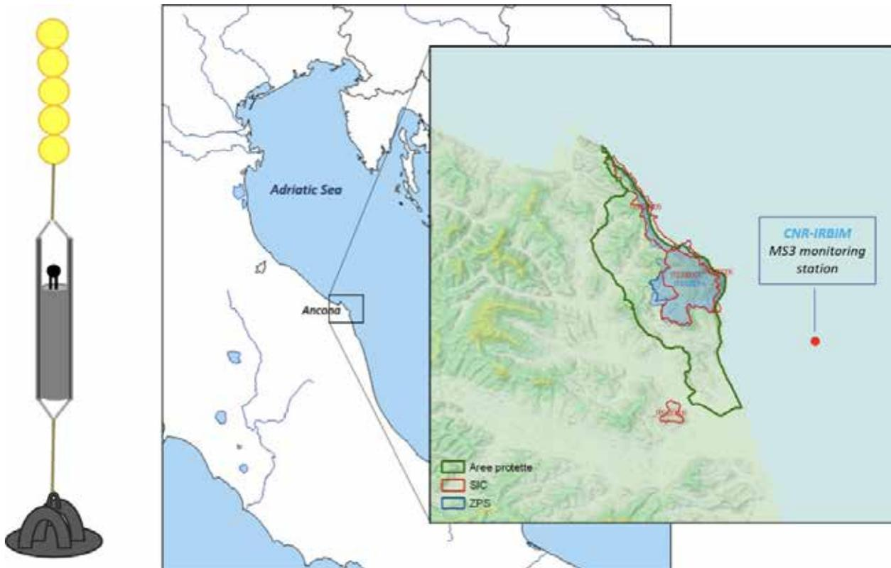
**Figura 1. Posizione della stazione di monitoraggio MS3 dell'Istituto CNR-IRBIM di Ancona. Sulla sinistra una rappresentazione schematica del mooring installato a mare, composto da: peso di zavorra in basso, strumento di registrazione acustica e boe di stabilizzazione verticale in alto.**
